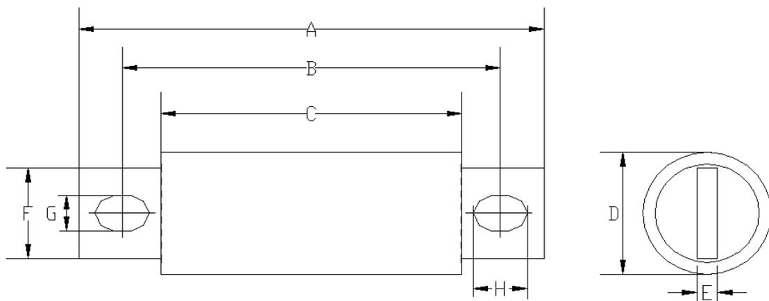
HMEV 车载及充电桩用直流熔断体外形尺寸图表
